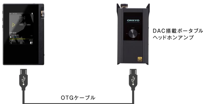
【USB-OTG デジタル出力による接続のイメージ】 (OTGケーブルは別売です)
