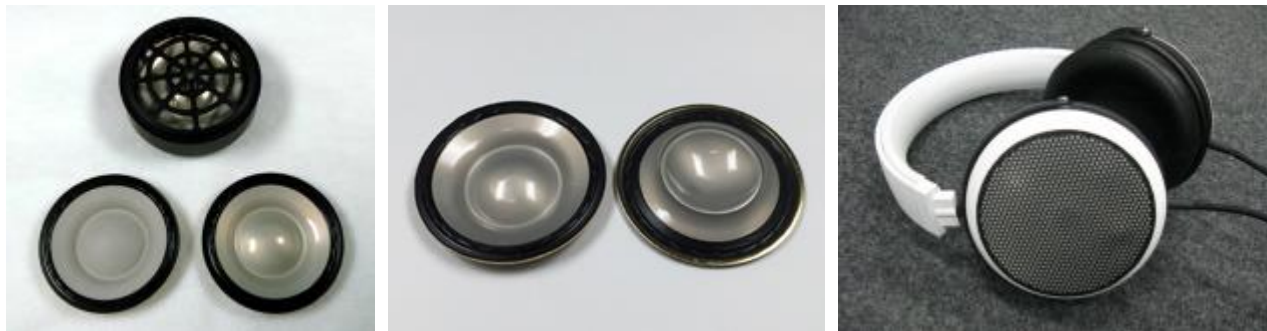
開発に成功したモノコックマグネシウム振動板と試作ヘッドホン
