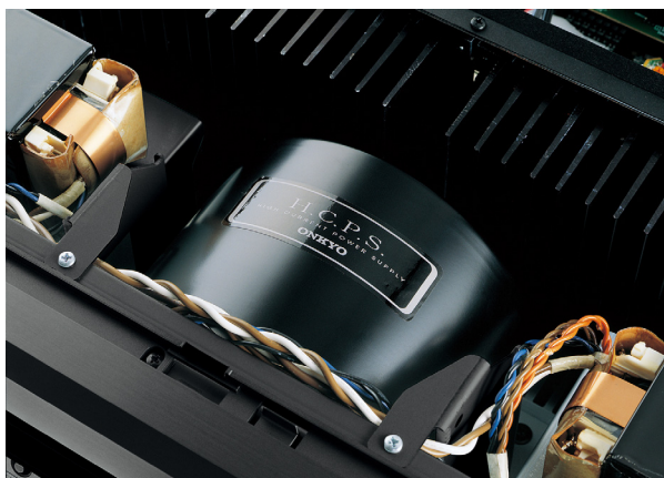
TX-NA5007の電源部には、大電流へのレスポンスに有利な大容量トロイダルトランスを搭載
