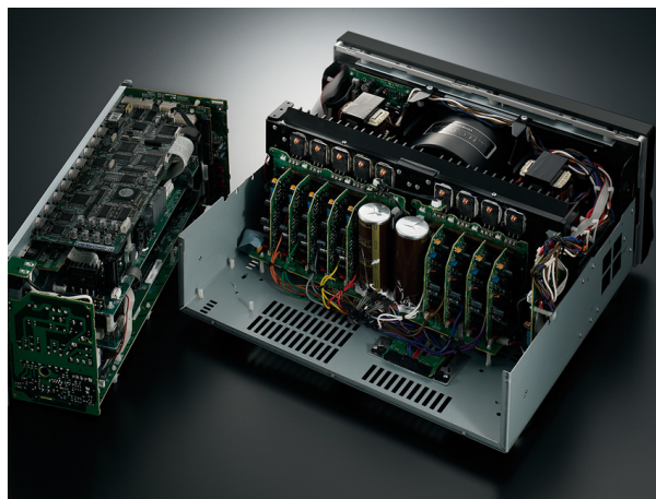
TX-NA5007 デジタル/ビデオ部(左)、電源部およびパワーアンプ部(右)
