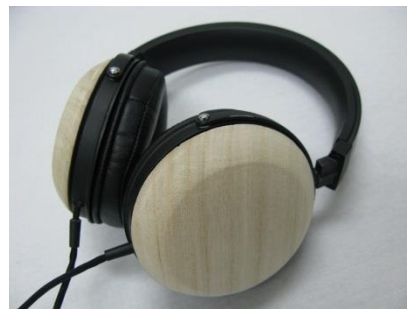
「桐」素材と「彫り」構造を応用して独自開発したスピーカーシステムとヘッドホン
