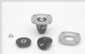
3cm径のリング型振動板採用のトイーター。中央部のイコライザーはアルミ削り出し。バック・チャンバー内部には粗めの吸音材が入っている
